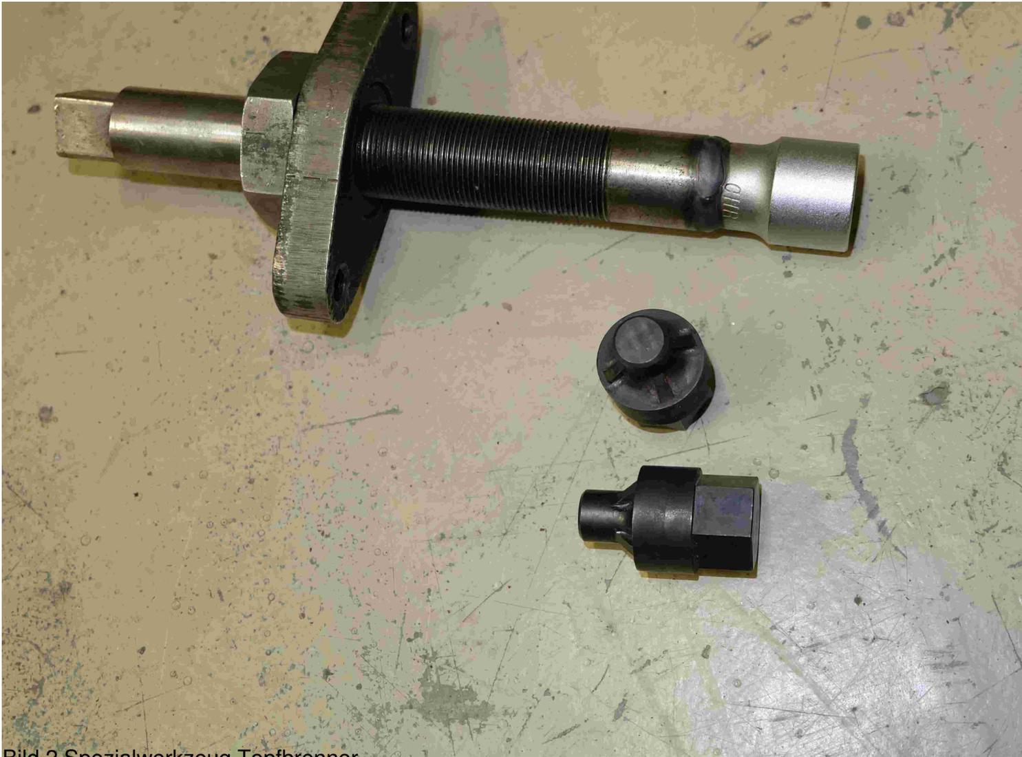
Bild 2 Spezialwerkzeug Topfbrenner
